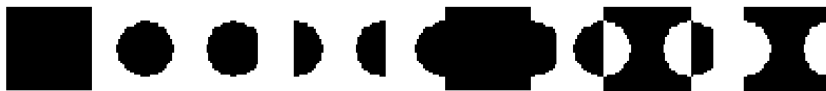
Image A Image B AND(A,B) OR(A,B) XOR(A,B) SUB(A,B)
